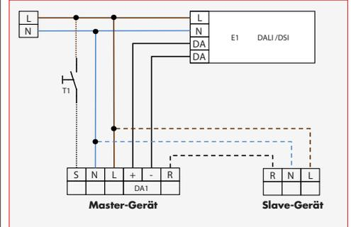
Angeschlossene Slave-Geräte müssen die gleiche Phase wie das Master-Gerät haben.
