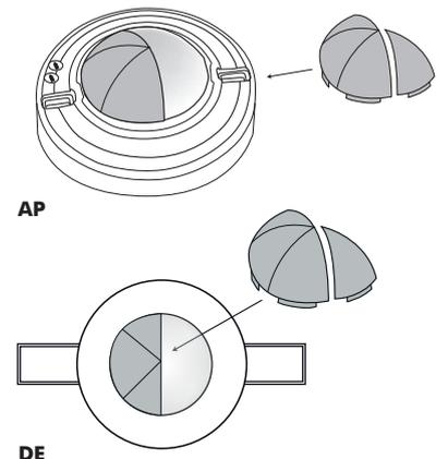
Falls der Erfassungsbereich des Melders zu groß ist oder Bereiche abdeckt, welche nicht überwacht werden sollen, kann mit den beiliegenden Lamellen (Blinds) der Bereich nach Bedarf reduziert bzw. eingeschränkt werden.
